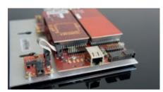
beroNet VoIP Gateways lassen sich mit bis zu 2 Modulen bestücken und sind daher sehr flexibel, sodass sie an unterschiedlichste Kundenanforderungen angepasst werden können.
